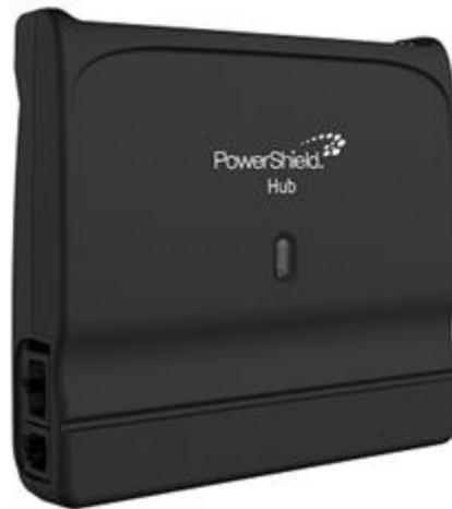
Le *Hub PowerShield* est utilisé pour connecter des capteurs externes permettant de mesurer le courant des chaînes et la température ambiante et possède un capteur d'humidité ambiante intégré. Chaque *Hub* peut lire à partir d'un seul Transducteur de courant et de jusqu'à deux sondes de température ambiante. Il dispose également de deux entrées à contact sec qui peuvent être utilisées pour lire l'état des dispositifs externes.
