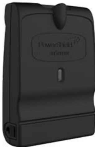
Le *PowerShield mSensor* se connecte aux blocs et mesure périodiquement la tension, la température et la valeur ohmique du bloc. Chaque *mSensor* est spécifique à la tension du bloc sur lequel il sera monté, par exemple 2 V / 6 V / 12 V.
